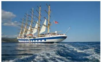
На «Royal Clipper» установлены два вспомогательных двигателя. Кроме дизельного, есть электрический, позволяющий судну развивать скорость 8 узлов. Причем оба двигателя, переключаясь, работают на один вал гребного винта.
