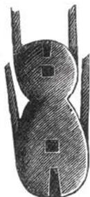
**ЛОНГ-ТАКЕЛЬНЫЙ БЛОК** — блок, в котором шкивы находятся между двумя щечками на разных осях, один над другим.
