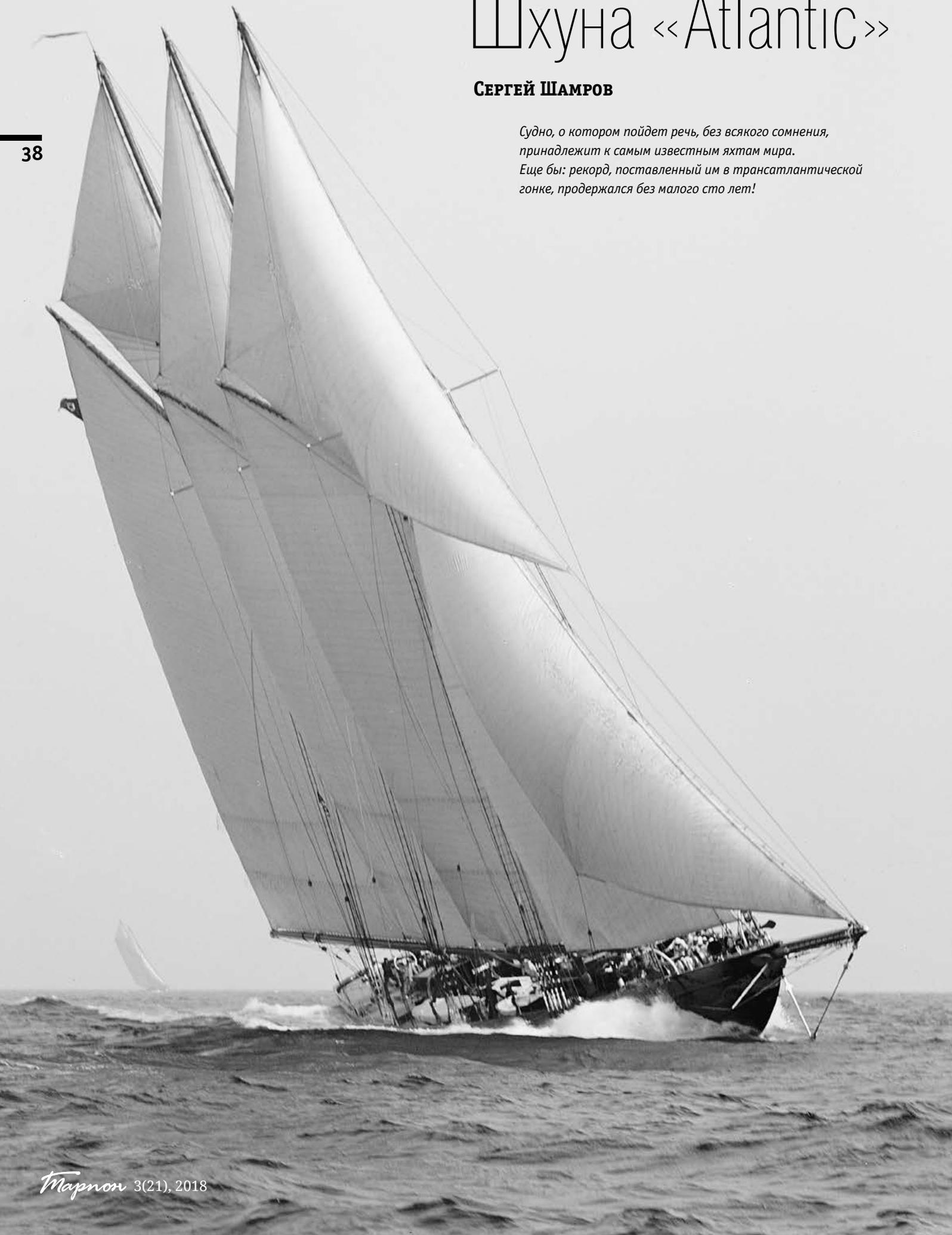
**Т**рехмачтовая 56-метровая шхуна «Atlantic», спроектированная Уильямом Гарднером — одним из лучших американских яхтенных конструкторов, была спущена на воду в 1903 г. Изящная седловатость невысоких бортов, длинные свесы в носу и корме (длина по ватерлинии 41 м), негроможденная надстройками палуба, относительно небольшая ширина корпуса (8,85 м), высокие мачты (45 м над ватерлинией), позволяющие поставить паруса общей площадью 1750 кв. м. Осадка шхуны составляла 4,9 м, а водоизмещение — 300 т.
