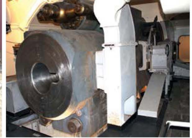
Затвор. С правой стороны — пост управления углом подъема ствола
