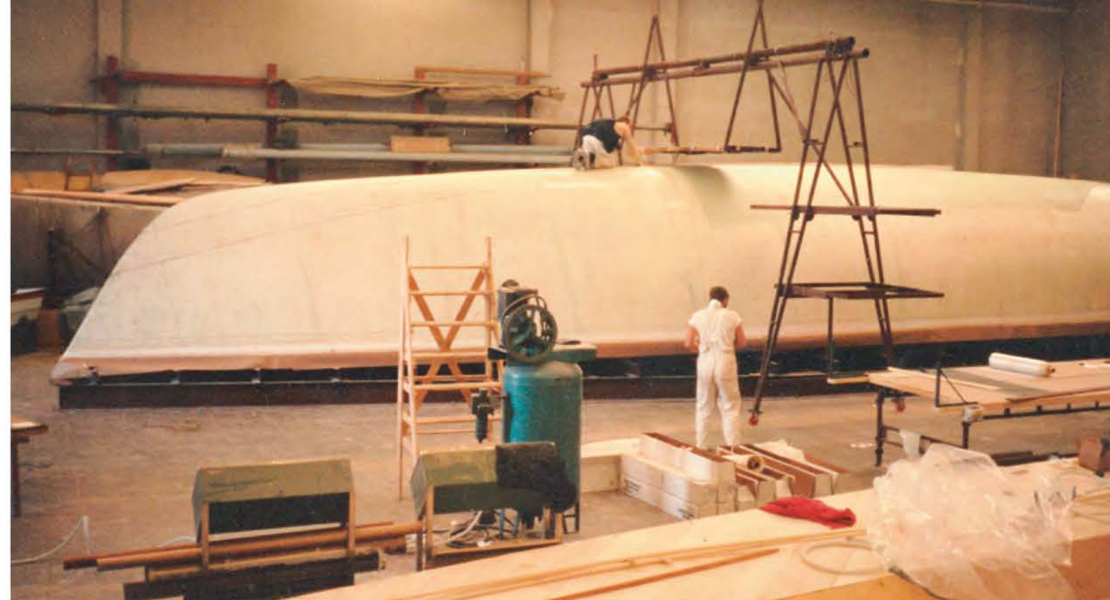
Строительство болвана подходит к завершению. После этого начнется формовка матрицы для последующего изготовления углепластикового корпуса
