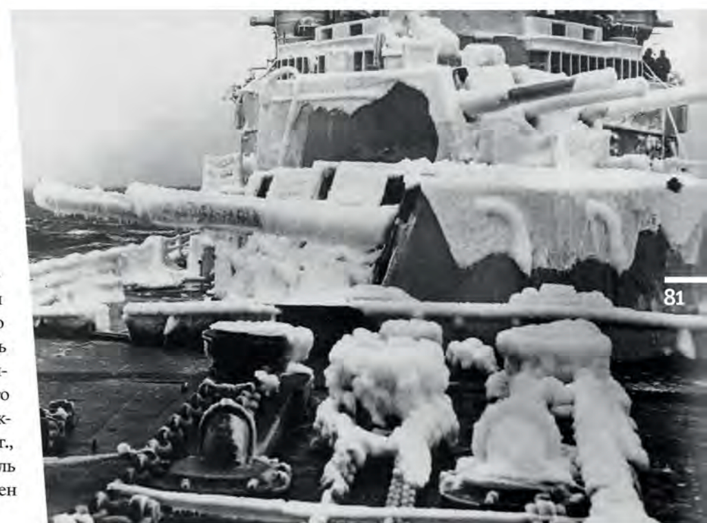
«Белфаст» в Арктике, ноябрь 1943 г. Из-за обледенения башни с орудиями главного калибра в море проворачивали, чтобы убедиться в возможности их использования в любой момент
