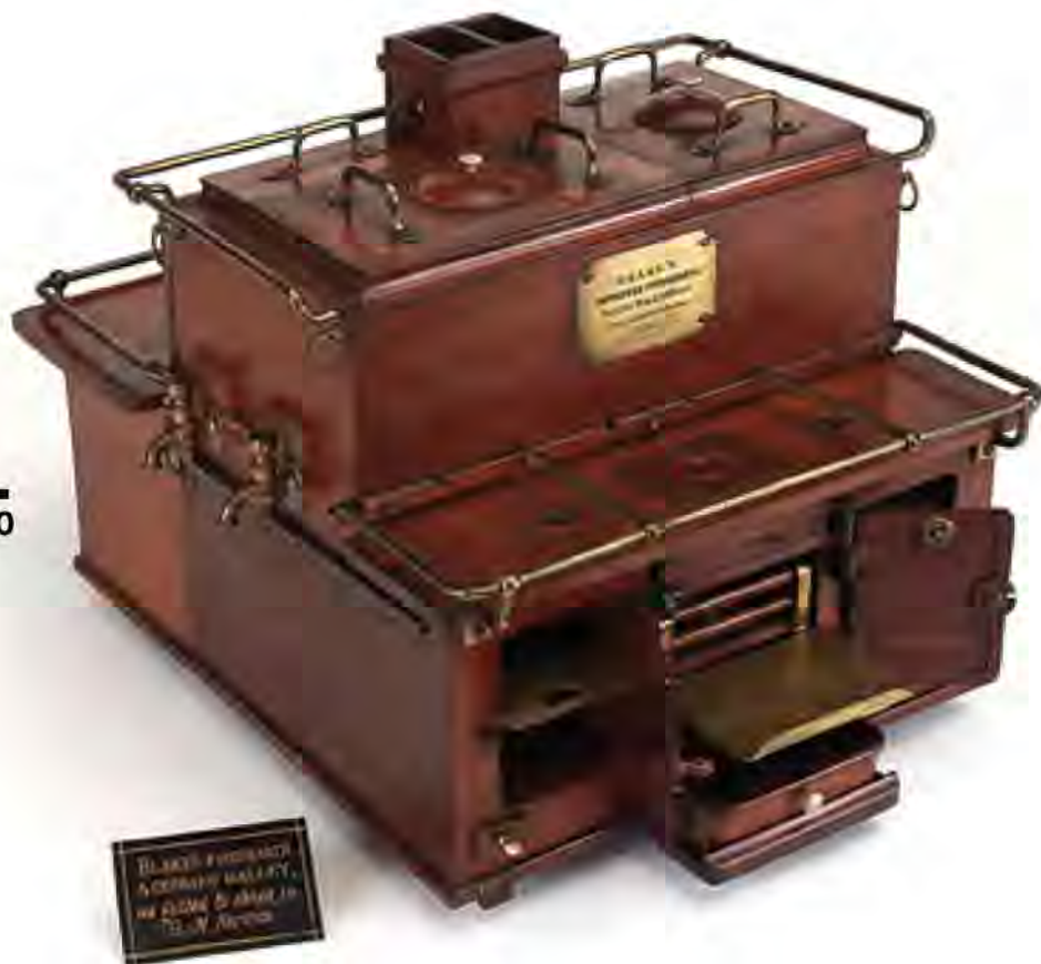
Модель камбузной печи, рассчитанной на экипаж 150 человек. 1868 г.
