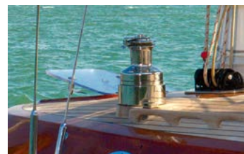
На яхте установлены уникальные электрические лебедки фирмы Andersen (Ronstan Danmark).
