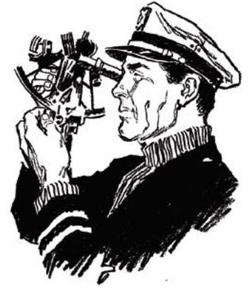
Секстан — навигационный измерительный инструмент, используемый для измерения высоты светила над горизонтом с целью определения географических координат той местности, в которой производится измерение. Например, измерив высоту Солнца в астрономический полдень, можно, зная дату измерения, вычислить широту местности.
