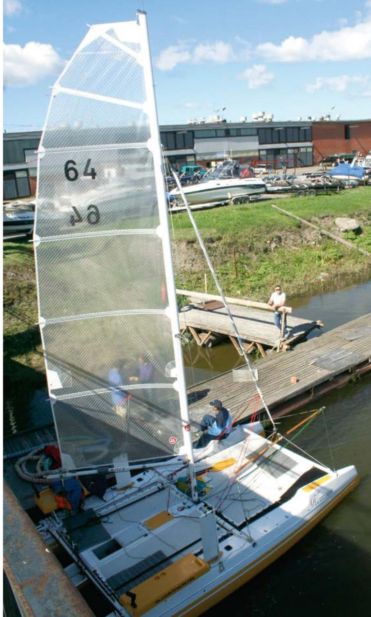
нья конструктивно закреплены на корпусах катамарана и вынесены за габарит корпуса для удобства управления и откренивания катамарана. Имеется возможность установки трапеций.
