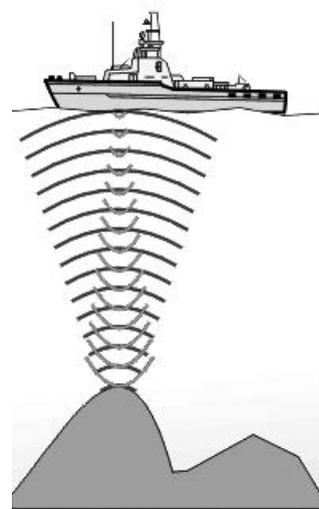
Сегодня для измерения глубины моря повсеместно используется эхолот — электронный навигационный прибор, работающий с помощью акустических эхосигналов.
