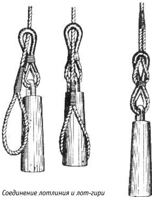
Соединение лотлиния и лот-гири с помощью стропки
