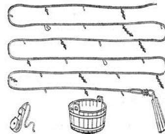
Для гидрографических работ, промеров больших глубин использовался специальный лот под названием «диплот». Его длина составляла не менее 200 м, а вес гири — 20–30 кг.
