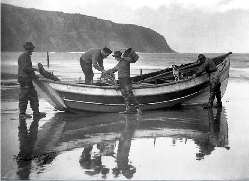
Кобл обычно имел длину от 7 до 10 м и строился из дерева, с клинкерной обшивкой из широких досок. Высокий борт в носу, корма с сильно наклоненным транцем и заметным завалом бортов внутрь, необычная форма днища, — вот его характерные черты. Главным двигателем кобла был высокий рейковый парус, вместе с которым часто ставили и небольшой стаксель. Боковое сопротивление обеспечивала хорошо заглубленная носовая часть лодки и узкий, очень длинный руль.
