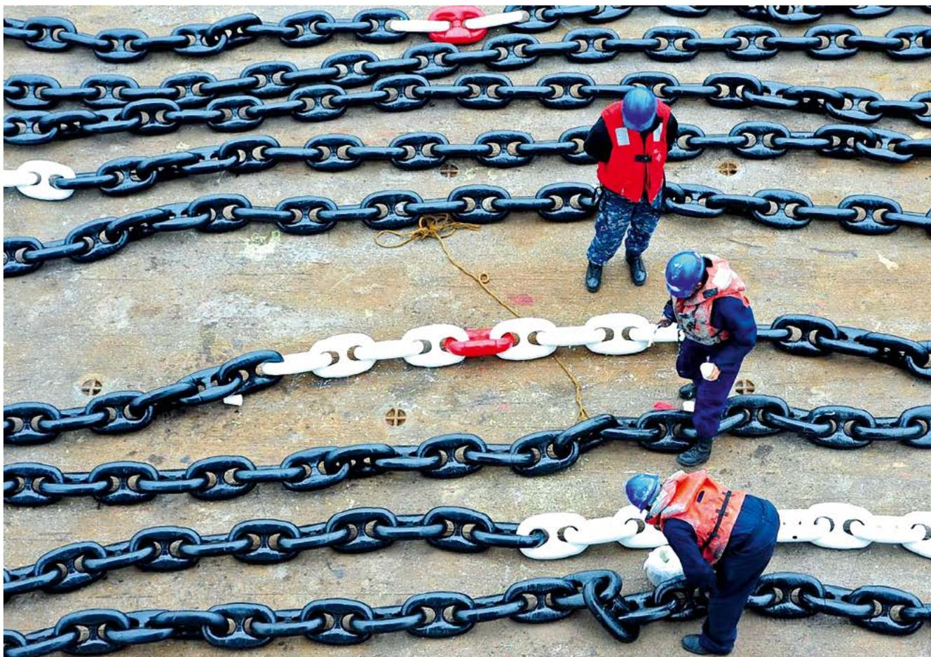
Отдельные части цепи — смычки, длина которых колебалась от 25 до 27,5 м — скрепляли между собой до необходимой длины соединительными скобами. Почему так повелось? Это позволяло в случае повреждения одного из звеньев отсоединить смычку с обнаруженным дефектом и отправить ее на ремонт или попросту заменить. Кроме того, составная якорная цепь позволяет при необходимости менять местами смычки (части ее изнашиваются неравномерно).
