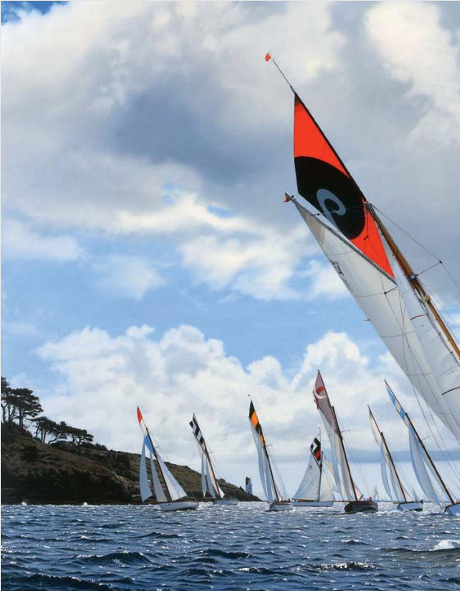
Длина Falmouth working boat колеблется от 22 до 32 футов, характерными для них являются прямой форштвень, длинный киль и практически вертикальный транец. Лодки открытые, палуба есть лишь в носу. Балласт обычно внутренний, мачта имеет стеньгу, на которой несут рейковый топсель, традиционно окрашенный в яркие цвета, что позволяет издали узнать конкретную лодку. Парусник несет высокий гафельный грот, стаксель и кливер. Длинный бушприт стоит параллельно воде, часто имеет сильный изгиб книзу.
