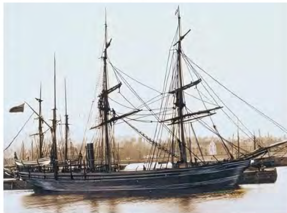
Трехмачтовый китобойный барк «Виндворд» («Windward»). 1860 г., верфь Stephen & Forbes, Шотландия. Длина 36 м, водоизмещение 321 т. Деревянный корпус усилен металлическими листами
