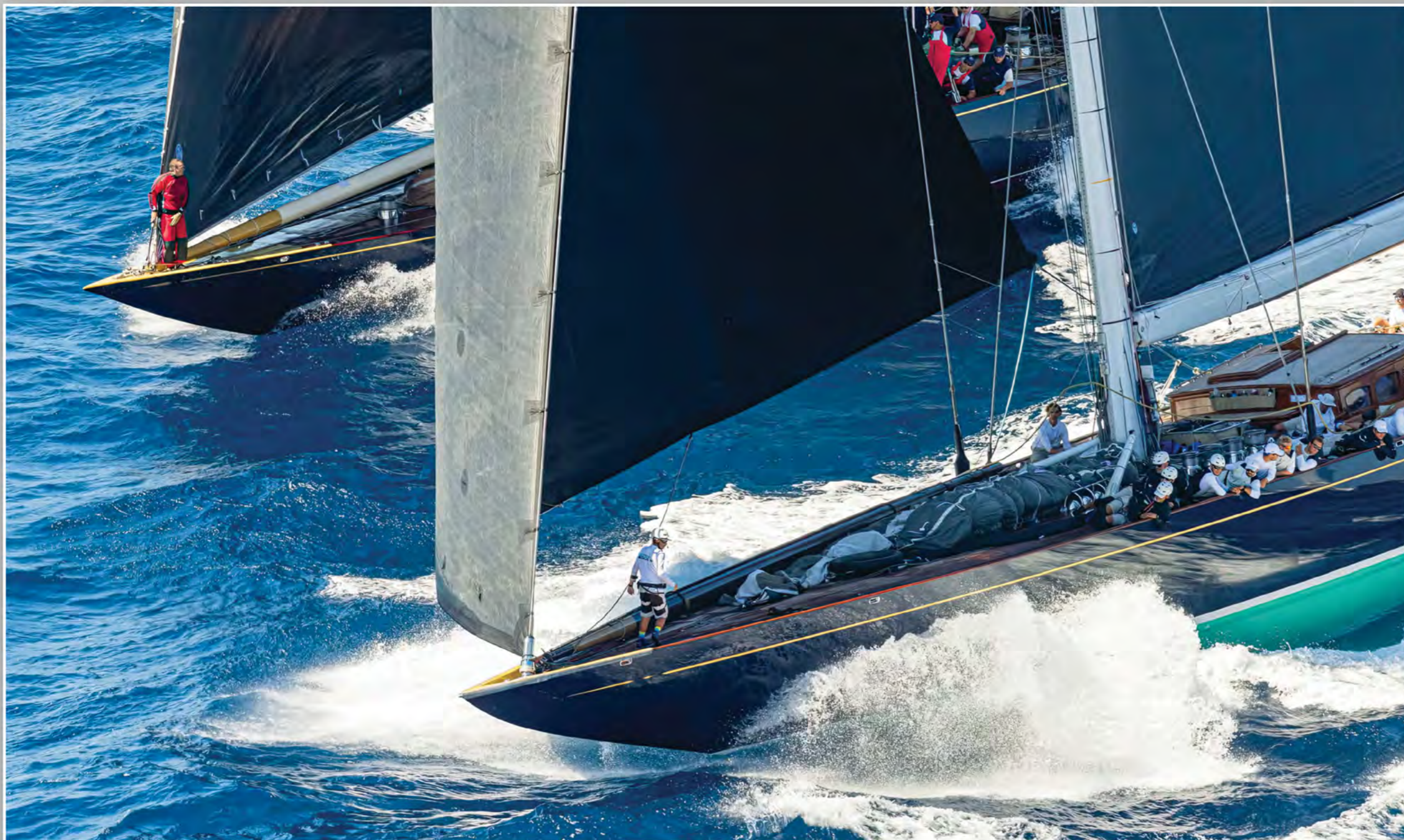
Основные размеры яхты «Endeavour»: Длина 39,50 м Длина по ватерлинии 25,50 м Ширина 6,70 м Осадка 4,50 м Водоизмещение 143 т Площадь парусности 711 кв. м
