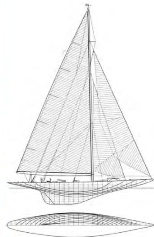
Основные размеры яхты «Endeavour»: Длина 39,50 м Длина по ватерлинии 25,50 м Ширина 6,70 м Осадка 4,50 м Водоизмещение 143 т Площадь парусности 711 кв. м
