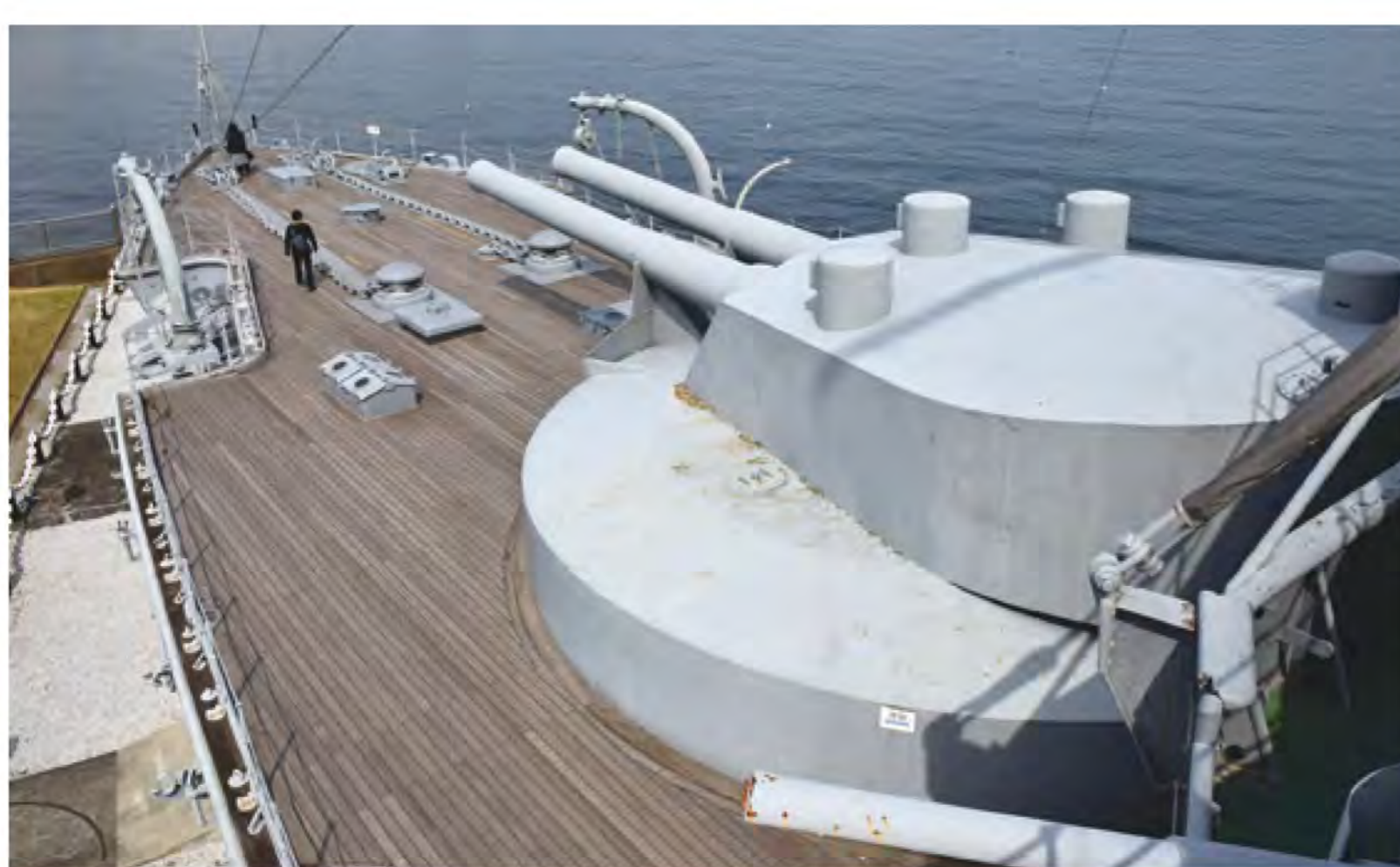
Вид с мостика на носовую часть броненосца. Швартовные и якорные устройства подлинные, но макет башни главного калибра выполнен довольно примитивно
